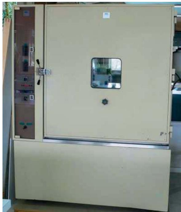
**Figura 15.** Cámara de humedad y temperatura. Fotografía: Fernando Suárez. IPCE.
